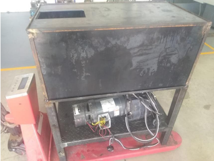
Fig: 16 se muestra la parte trasera de la trituradora donde se muestra el motor Trifásico
